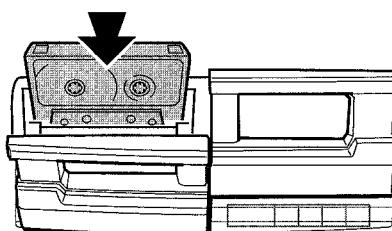
Inserte una cinta con el lado expuesto hacia abajo. Empuje el portacasete para cerrarlo.
